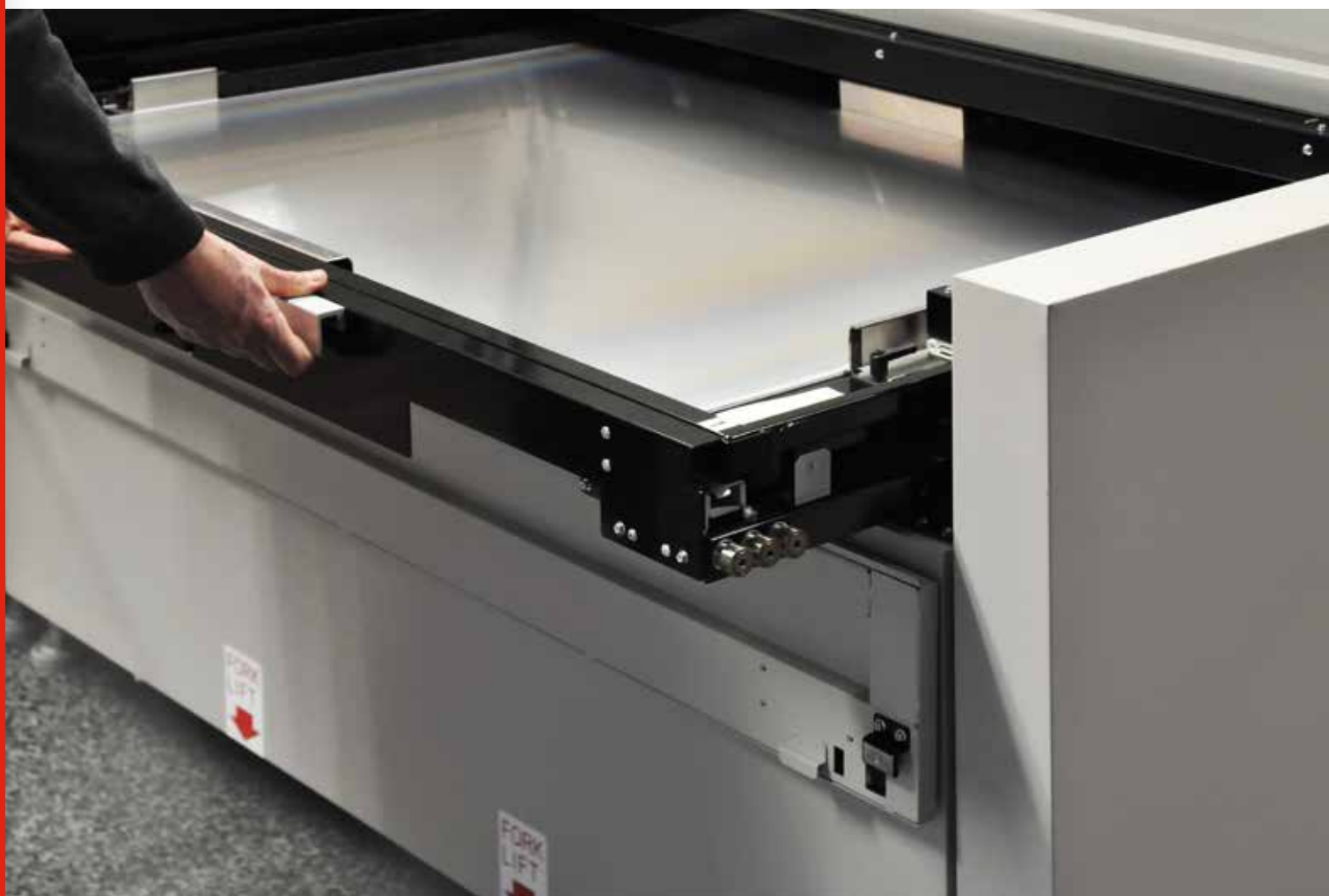
Automazione del caricamento lastre per stampa non presidiata
