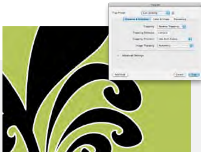
PowerTrapper incorpora un'impostazione predefinita per il "trapping inverso" dedicata appositamente alle lattine metalliche.
